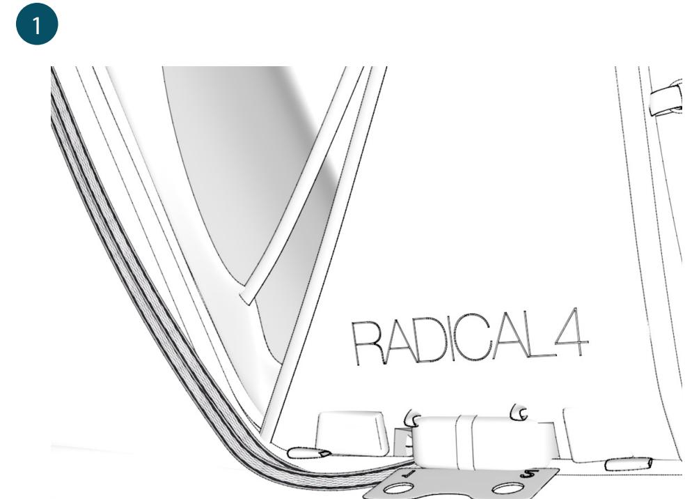
Insérez le parachute et son POD dans le container secours. Les suspentes doivent être positionnées vers le bas.
