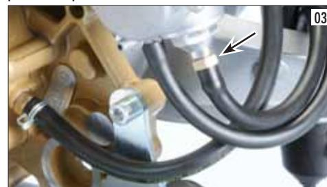
**ATTENTION!** Ne jamais dévisser plus d'un demi-tour l'écrou de soupirail pour éviter d'endommager le joint de tenue. Ne jamais serrer avec trop de force.
