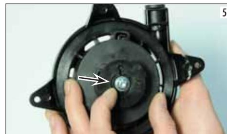
**ATTENZIONE!** Sotto il coperchietto vi sono 2 denti di innesto avviamento (verificarne l'usura ed eventualmente sostituirli) al di sotto degli stessi 2 mollettine di dimensioni ridotte. prestare la massima attenzione per evitare di perdere questi particolari Preparare il cordino nuovo facendo un nodo ad un capo dello
