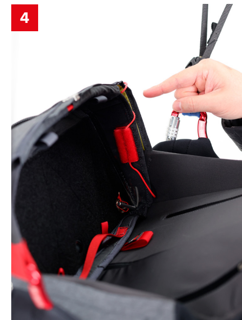
Guarde la línea adicional en el bolsillo dedicado y pegue el velcro en el costado del cockpit
