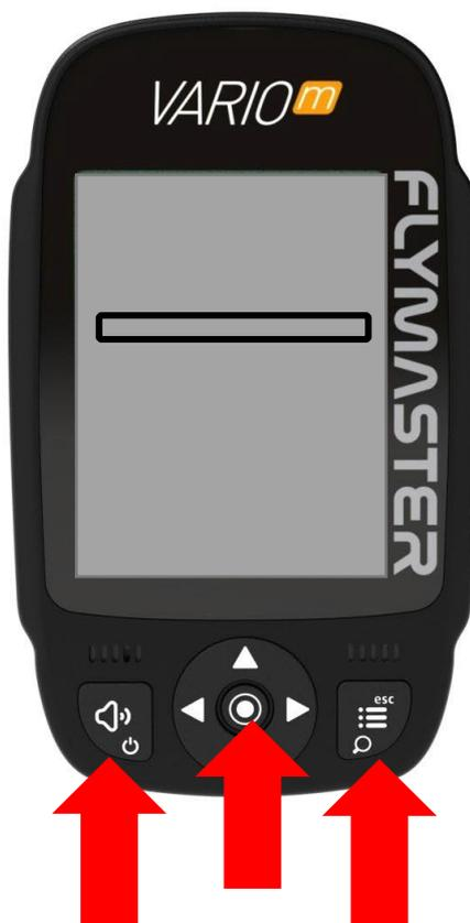
Si por alguna razón tu instrumento no arranca y sigue reiniciándose sin ninguna razón aparente, es posible ponerlo en "modo de recuperación" para poder restaurar el firmware a través de Flymaster Instrument Manager.
