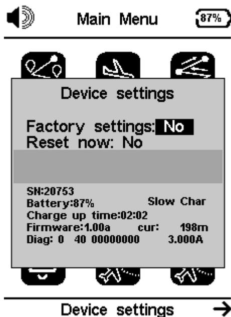
**Configuración de fábrica** - Restablece todos los parámetros a los valores de fábrica por defecto. Esto no cambiará la disposición a la disposición por defecto de fábrica. Hay que tener cuidado porque todos los cambios de realizados por el usuario se pierden.
