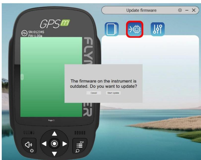
**Actualización automática del firmware** - Después de lanzar la aplicación "Flymaster Instrument Manager" y si tu instrumento está conectado al puerto USB de tu ordenador, es posible que haya una nueva versión de firmware disponible para tu instrumento. Si quieres actualizarlo, sólo tienes que responder a "iniciar la actualización" y el proceso será automático. Su instrumento se reiniciará y aparecerá una barra de progreso.
