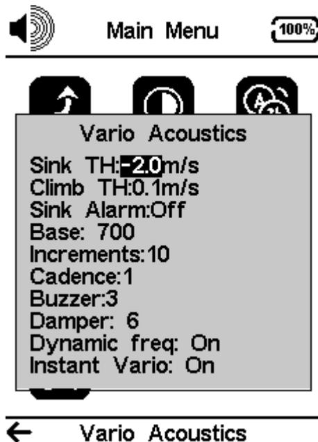
La opción de menú de ajustes de acústica del vario permite al usuario cambiar los parámetros relacionados con el sonido del vario. El usuario puede cambiar el sonido de la velocidad de ascenso y descenso a través de los respectivos valores de umbral. Estos umbrales corresponden a las tasas de subida y bajada a las que se activa el sonido. El usuario también puede definir en la opción de Umbrales Acústicos la alarma de hundimiento y el volumen de sonido de es el VARIO M.
