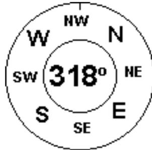
El elemento Brújula muestra todos los datos proporcionados por la brújula magnética integrada en el VARIO M. La brújula incluye una flecha superior roja que siempre está alineada con el VARIO M. Si se gira el VARIO M los puntos cardinales también girarán para que la punta de la flecha apunte al punto cardinal correcto.
