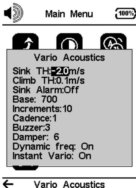
La opción de menú de ajustes de acústica del vario permite al usuario cambiar los parámetros relacionados con el sonido del vario. El usuario puede cambiar el sonido de la velocidad de ascenso y descenso a través de los respectivos valores de umbral. Estos umbrales corresponden a las tasas de subida y bajada a las que se activa el sonido. El usuario también puede definir en la opción de Umbrales Acústicos la alarma de hundimiento y el volumen de sonido de es el GPS M.
