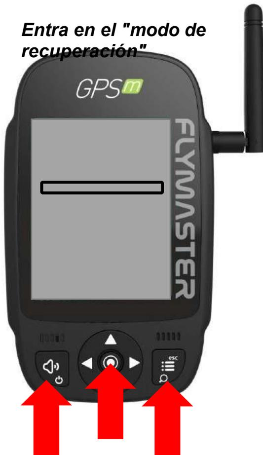
Si por alguna razón tu instrumento no arranca y sigue reiniciándose sin ninguna razón aparente, es posible ponerlo en "modo de recuperación" para poder restaurar el firmware a través de Flymaster Instrument Manager.
