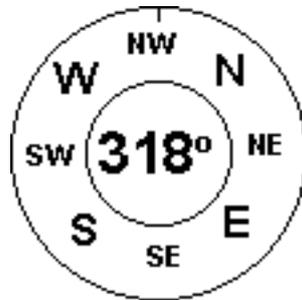
El elemento Brújula muestra todos los datos proporcionados por la brújula magnética integrada en el GPS M. La brújula incluye una flecha superior roja que siempre está alineada con el GPS M. Si se gira el GPS M los puntos cardinales también girarán para que la punta de la flecha apunte al punto cardinal correcto.
