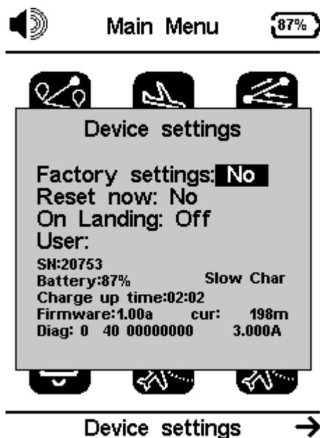
**Configuración de fábrica** - Restablece todos los parámetros a los valores de fábrica por defecto. Esto no cambiará la disposición a la disposición por defecto de fábrica. Hay que tener cuidado porque todos los cambios realizados por el usuario se pierden.
