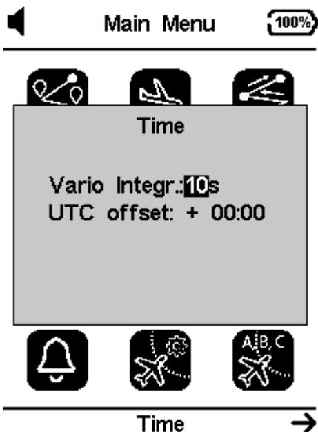
**Integrador del vario** - El vario integrado se calcula integrando la velocidad vertical durante un periodo de X segundos definido por este valor. En el ejemplo, el periodo de integración es de 5 segundos (valor por defecto).
