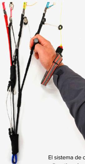
El sistema de control de bandas C se puede realizar tirando gradualmente de la barra como se muestra en la imagen.
