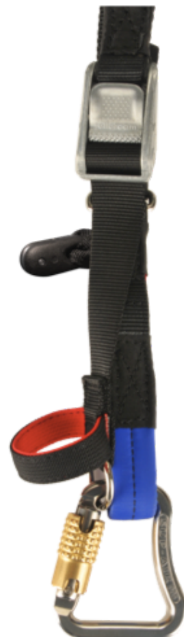
Fig. 6: Vue globale des élévateurs avec le Trim attaché entre le mousqueton et la poulie de frein
