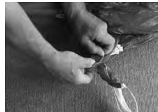
7. Mediante la ayuda de unas pesas metálicas iremos plegando el paracaídas en forma de "S" y del tamaño del contenedor.
