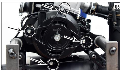
Rimuovere il nodo della maniglia. Fare attenzione perché la ruota centrale ruoterà fino a completo scaricamento della molla; trattenerla e farla scaricare lentamente in modo da evitare danni e pericolo di farsi male. Rimuovere la vite centrale ed il relativo coperchio (foto 7).
