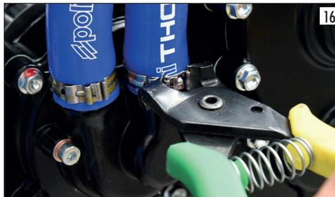
È possibile posizionare il radiatore anche in basso (esplos0 B). Per agevolare il passaggio del tubo acqua sulla testa si dovranno utilizzare due raccordi a 90° cod. 928.225.004 e 928.225.006 (non forniti). In questo caso si consiglia di prestare molta attenzione al posizionamento del radiatore che dovrà trovare una collocazione adeguata ed un fissaggio robusto. Posizionare eventuali raccordi di sfiato (928.225.006 e 929.225.004) per evitare la formazione di sifoni (esplos0 B).
