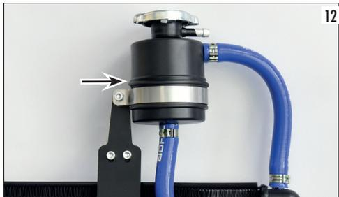
Rabboccare eventualmente il circuito utilizzando del liquido di raffreddamento specifico per radiatori in alluminio.
