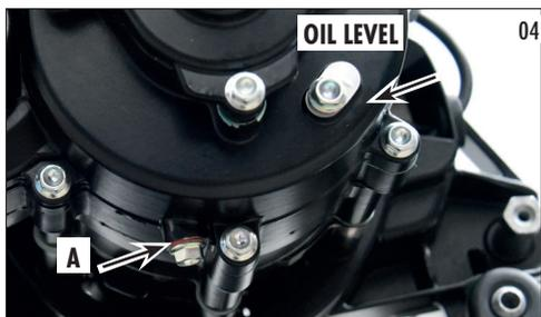
Raccogliere l'olio che ne fuoriesce in un contenitore. Attendere che tutto l'olio all'interno fuoriesca ed eventualmente inclinare leggermente il motore per facilitare l'operazione. Riavvitare saldamente la vite. Svitare il raccordo/sfiato posto nella parte superiore del carter (foto 5)
