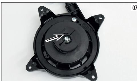
**⚠ ATTENZIONE!** Sotto il coperchietto vi sono 2 denti di innesto avviamento (verificarne l'usura ed eventualmente sostituirli) al di sotto degli stessi 2 mollette di dimensioni ridotte. Prestare la massima attenzione per evitare di perdere questi particolari. Preparare il cordino nuovo facendo un nodo ad un capo dello stesso. Rimuovere la ruota in plastica e il vecchio cordino. Infilare il nuovo cordino nell'apposito foro (foto 8),
