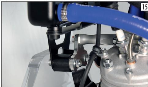
Montare sulla staffa i due gommini e appoggiare il radiatore. Per fissare il radiatore nella parte superiore vengono forniti una staffa ed un gommino. Utilizzando l'apposita fascetta in acciaio posizionare e fissare il vaso di espansione del liquido sopra il radiatore nell'apposita sede (foto 12). Tagliare a misura i tubi dell'acqua e montarli. Chiudere le fascette in dotazione utilizzando una pinza apposita (foto 16).
