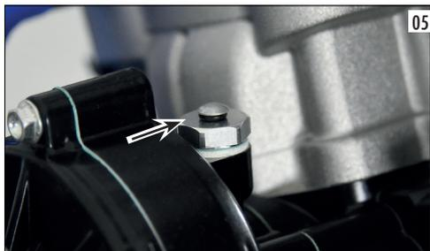
ed inserire 100 cc di olio tipo ELF MOTO GEAR OIL 10 W 40 ANTI CLUTCH SLIPPAGE. Riposizionare il raccordo/sfiato. In alternativa si può utilizzare anche olio tipo: Shell advance gear SAE 10 W 40 API GL-3 oppure un olio motore viscosità 10W40 compatibile con frizione (tipo olio motore per motociclette).
