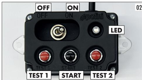
Tale consolle va fissata in una posizione comoda e accessibile al pilota. Il motore è provvisto di due accensioni separate e la consolle consente di verificare il corretto funzionamento di entrambe le accensioni.
